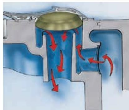
Wenn das Hauptventil die Abluft austreten lässt, leitet das Quick Dump™- Ventil die kalte/feuchte Abluft aus der Membrankammer vom Hauptventil weg. Somit wird eine Eisbildung in den kritischen Ventilbohrungen verhindert.
