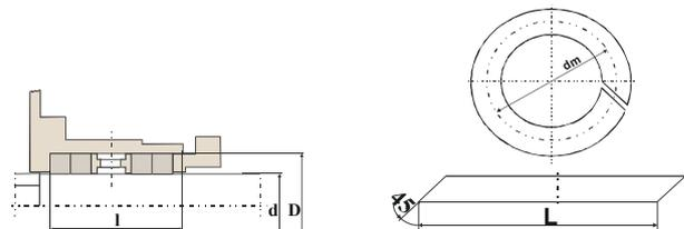
Bild 5: Packungsdichtung
