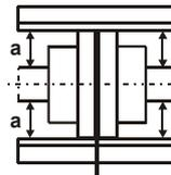
Bild 2: Kupplungsausrichten
