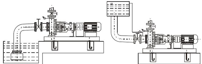
Fig. 4 Fissaggio tubazioni
