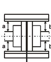
Fig. 2 Allineamento giunto
